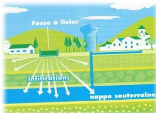
Figure. Contamination des eaux souterraines par une fosse à lisier fissurée
